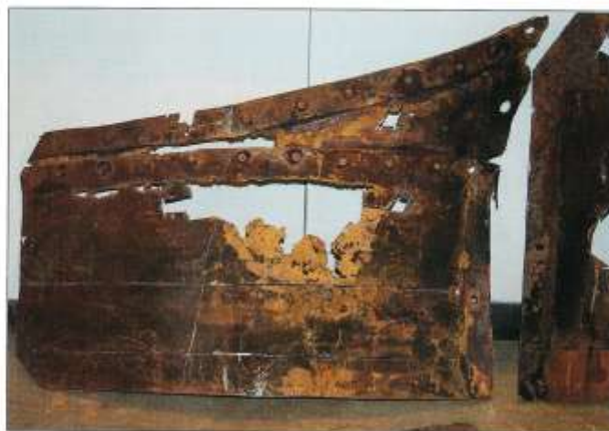
Plåten i röskuptaget från ångpannan i BOHUSLÄN var genomfrätt av svarvel och vatten. Det var med all sannolikhet orsaken till sommarens problem med eldningsen och därmed svårigheten att hålla tryck och fart. Jämför med bilden på sidan 3! Foto Bo Starmark.
