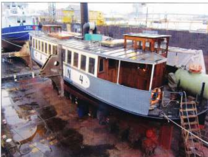
FÄRJAN 4 med nymålat skrov i Gotenius lilla flytlocka. Närmast i bild aktern med rodret ställt för gång framåt. Vid höggång svängs båda rodröven 180 grader. Foto Per Ahlqvist 24 november 2012
